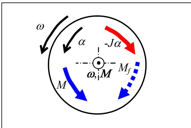
Gred z vztrajnikom vztrajnostnega momenta  $J$  se vrti s kotno hitrostjo  $\omega$ , ki se ji povečuje jakost s kotnim pospeškom  $\alpha$ . Tega zagotavlja zunanji navor motorja, zato je predznak in usmeritev
