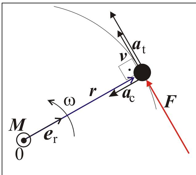
Zunanja sila  $F$  naj deluje na krožčeče točkasto telo v tangencialni smeri, stalno spreminja smer, ki je vzporedna hitrosti telesa. Telo naj je pritrjeno s togo palico dolžine  $r$  v osišče  $O$  in naj okrog njega kroži brez trenja (idealen ležaj). Sila izvaja navor glede na osišče
