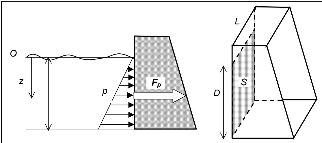
Zračni tlak na gladini in okoli jezu zanemarimo. Vodna masa deluje na vertikalno ploskev površine  $S = DL$  s tlačno silo in z navorom te sile. Sile tlaka na jez je:
