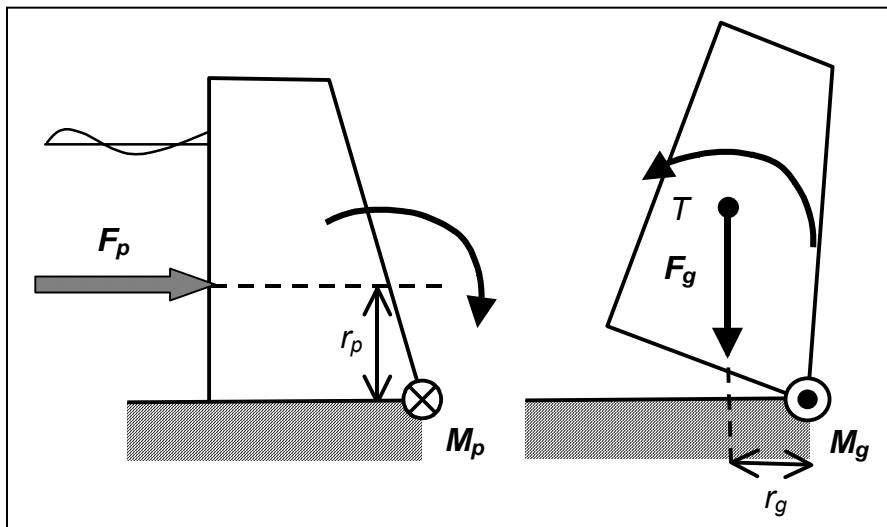
Sila tlaka prijemlje v višini  $r_p$ , navor te sile  $M_p = r_p F_p$ , druga je sila teže jezu, ki ustvarja povratni navor  $M_g = r_g F_g$ . Za stabilnost mora veljati:
