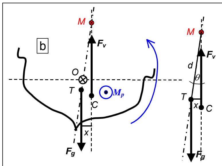
Razdalja med težiščem in metacentrom  $TM = d$  se imenuje *metacentrična oddaljenost*, njen horizontalna projekcija je
