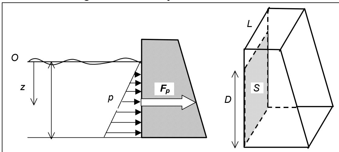
masa deluje na vertikalno ploskev površine  $S = DL$  s tlačno silo in z navorom te sile. Sile tlaka na jez je:
